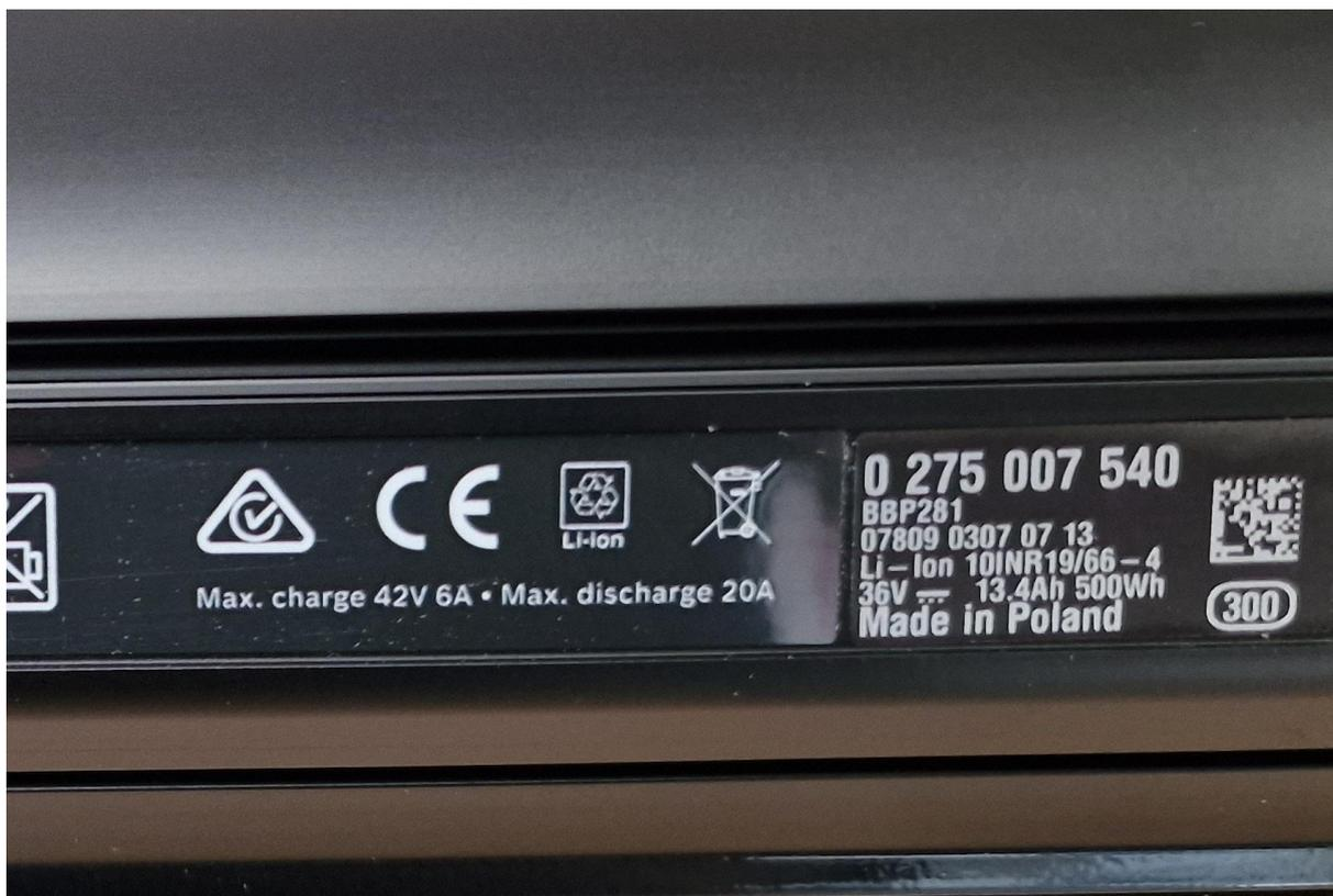
Vaya lío ¿verdad? Supongamos una **batería** etiquetada como **36V- 13.4 Ah ó 500 Wh** de capacidad total. ¿Qué nos quiere decir esto? Pues muy sencillo. Si esta batería alimenta a un motor de una **e-bike** como un **Shimano EP8** que mantiene **500 vatios** de potencia sostenida sin pestañear, nuestra autonomía máxima sería exactamente de 1 hora. Si en lugar de ir a tope, mantenemos el motor aportando **250 vatios**, la batería nos durará **2**
